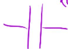
Kondensator (wird aufgeladen wie Batterie)
